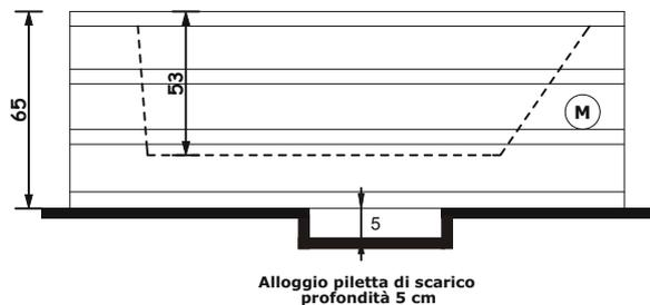
Motore Idromassaggio **M** Whirlpool Motor
